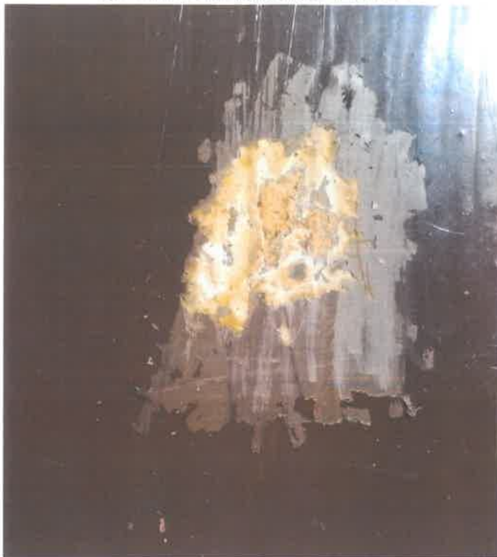
Sonda na ploše z vnitřní strany. Pod stávajícím hnědým nátěrem prokázána emailová vrstva ve středně hnědém odstínu, následuje odstín lomené bílé (světlá slonová kost), tmely na dřevěném podkladu.
